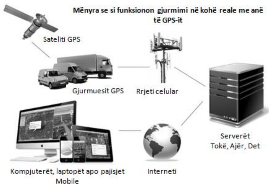
Figura 11- Operimi i sistemit GPS “tracking” në kohë reale
