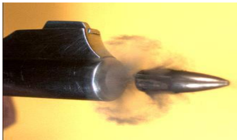
Foto. 1 Gazrat që liron arma në momentin e shkrepjes dhe daljes së predhës nga tyta
