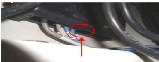
Pozicioni i portës Ethernet për t'u përdorur për lidhjen e PC (hiqni kapakun)
