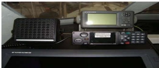
Radio Sepura me altoparlantë, ekran Navtex
