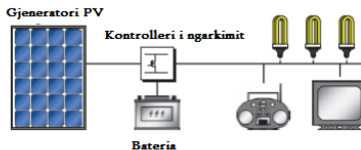
Fig. 2.108 Një sistem diellor shtëpiak me ngarkesë të rrymës së vazhduar
