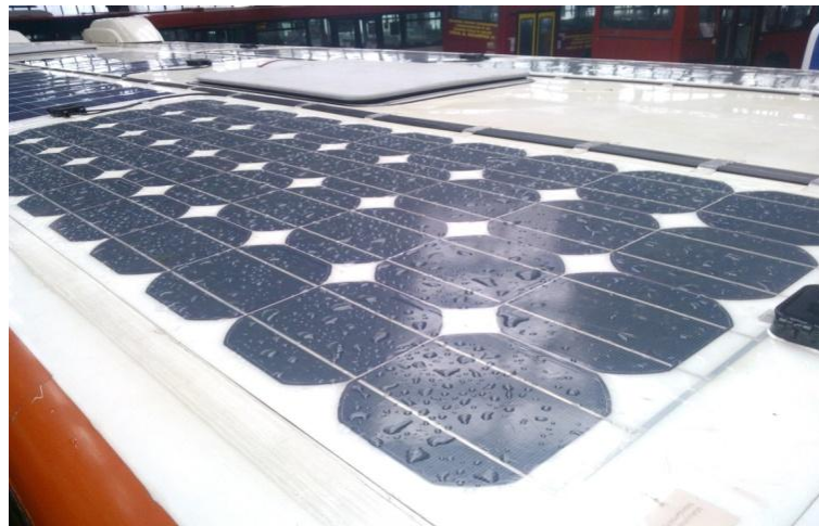
Fig. 3.9 Paneli diellor “Midsummer” I vendosur në pjesën e sipërme të një autobusi
