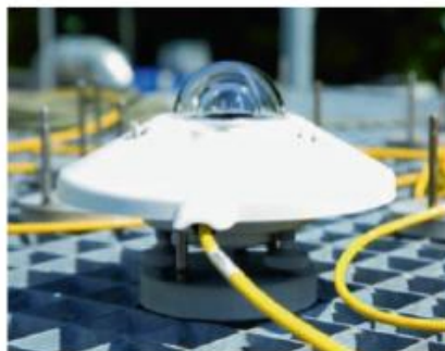
Fig. 2.15 Ndërtimi dhe pamja e një piranometri (photo: Kipp and Zonen)
