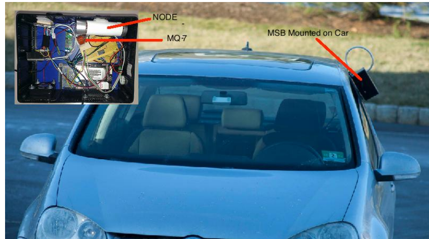
Fig. 5 MSB e montuar në automjet (Srinivas Devarakonda)
